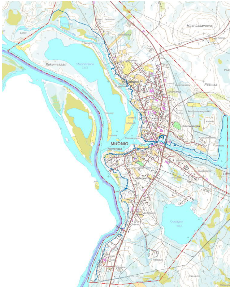
Kuva 28. Muonion vedenkorkeusaseman kerran 100 vuodessa toistuvaa tulvavedenkorkeutta vastaava korkeustaso perustuen 10x10 m korkeusmalliin.
